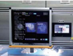
AIを活用した自動選別機。上のカメラでチーズのはみ出しや形状、コンペヤの下のカメラより製造日の印字、斜め上のカメラよりリシュリンクの破れなどを検査
